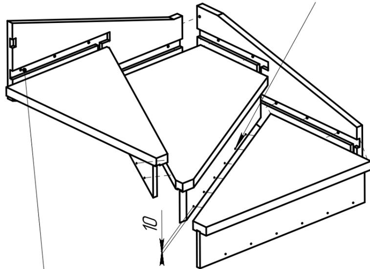
Расверлить подступенки сверлом диаметр 4мм.
