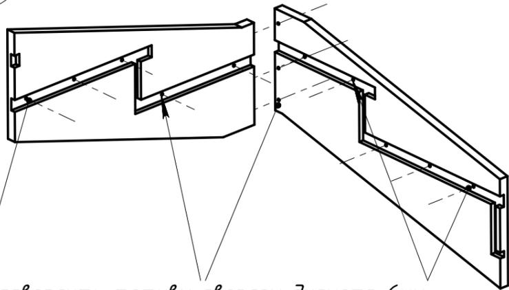
Расверлить тетивы сверлом диаметр 6мм.
