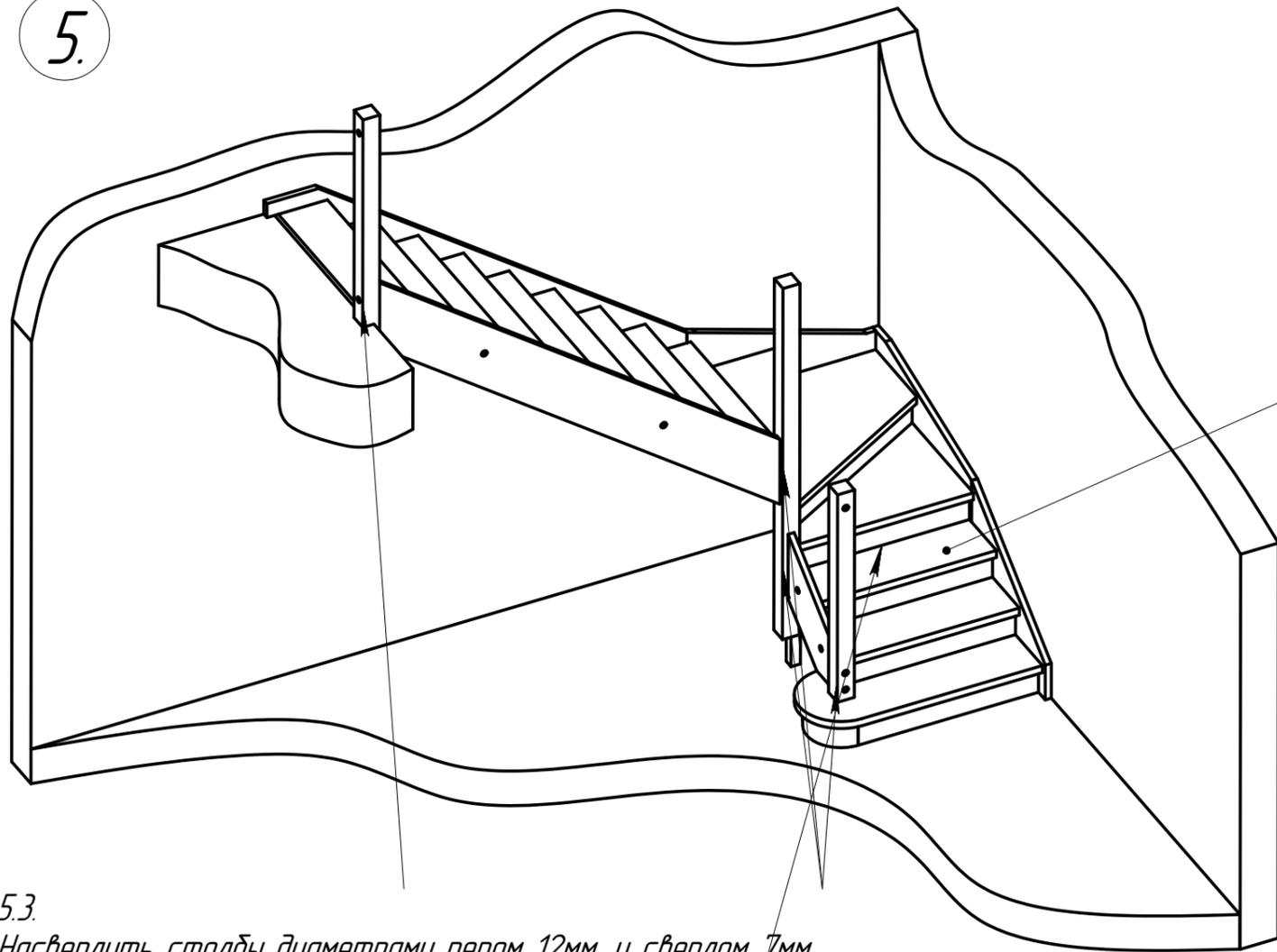
5.3. Насверлить столбы диаметрами пером 12мм. и сверлом 7мм.
